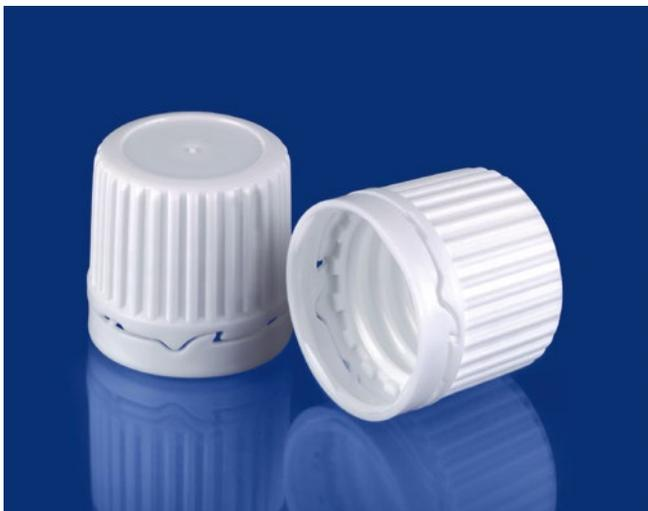
Originalitätsverschluss mit spezieller Kontur des OV-Ringes, der ein vorzeitiges Reißen der Anbindungen beim maschinellen Verschließen minimiert. Die gebrochene Originalität nach dem ersten Öffnen ist dadurch leichter erkennbar. Des weiteren überzeugt der Verschluss durch seine einwandfreie Abreißfunktion!
